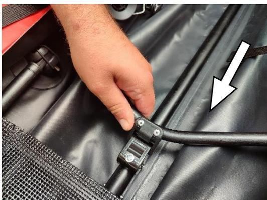
**Sitzspant (#8)** schräg an den Aufnehmer der Kielstange ansetzen und aufrichten....
