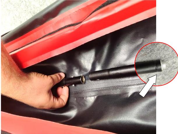
**Kielstange 1 (mit Kugel) (#3)** mit Bugsteven verbinden.
