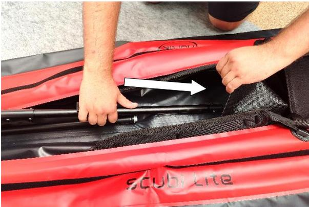
**Kielstange 2 (#4) (mit Halbrohr)** unter dem Sitz in Richtung Heck schieben und mit **Kielstange 3 (#5)** verbinden.
