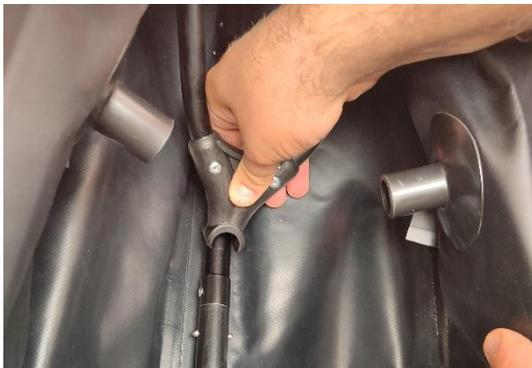
**Bugspant (#6)** (U-förmig) auf den Kiel des **Bugstevens** aufclipsen und die Enden in die Aufnehmer der Seitenschläuche stecken.
