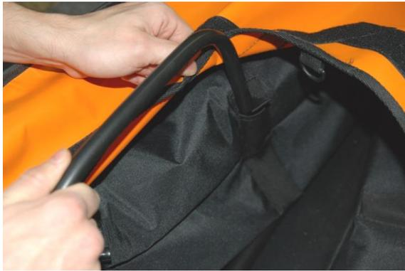
Nehmen Sie anschließend die beiden kleineren Halbspanten zur Hand. Diese fädeln Sie bitte vor und hinter dem Cockpit in die dafür vorgesehenen Taschen an den Luftelementen von oben her ein. Dabei ist wichtig, dass die Halbspanten wirklich **ganz** in den Taschen stecken.
