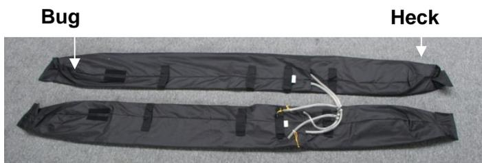
Breiten Sie die Luftelemente aus. Leicht hinter der Mitte sind die beiden Luftelemente (bestehend aus jeweils zwei Luftschläuchen) miteinander verbunden. Die Verbindungsschläuche dienen dem Druckausgleich. Die Befüllschläuche sitzen nachher hinter dem Cockpit. Die **Klettstreifen** auf den Schläuchen gehören in **Richtung Bug**.
