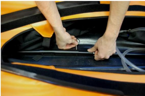
Die beiden Stangen werden dann im Boot mit dem Splint verbunden.
