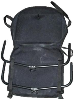
Die beiden größeren Halbspanten werden durch die Laschen an der Unterseite des Sitzes eingefädelt.
