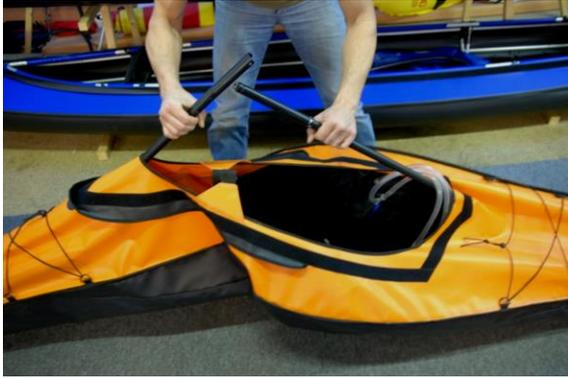
Anschließend werden Bug- und Heckelement miteinander verbunden.
