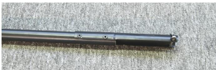
Der Steven, auf den Sie die **Kielstange mit dem aufgenietetem Halbrohr** gesteckt haben, bildet nun das **Bugelement**.
