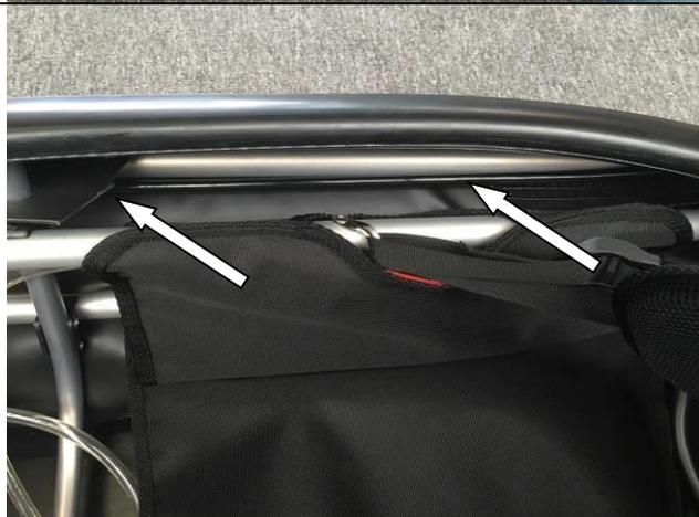
Führen Sie dann den Bowdenzug von hinten nach vorne ins Cockpit. Führen Sie ihn ganz außen und seitlich oberhalb des Spantes # 6, #5 nach vorne. An dieser Position stört er auch bei Beladung in keiner Weise.
