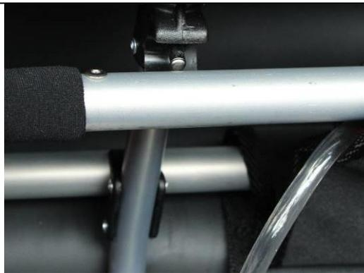
Die Schenkelstützen haben auf Höhe des Halbspants ein Loch, in welches der Stift des Halbspants gehört.
