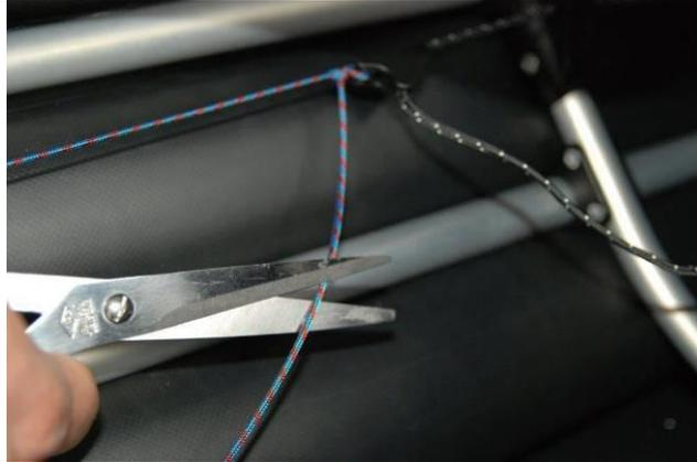
Kappen Sie das überschüssige Seil (welches aus dem Bowdenzug stammt) und verschmelzen Sie das Schnittende etwas mit einem Feuerzeug.
