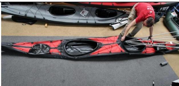
Führen Sie zunächst das **Heckelement** in die Bootshaut ein. Dieses wird durch die **vordere Sitzluke** in die Haut geschoben.
