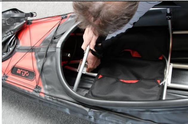
Dann folgt Spant #5. Der Beschlag für die Aufnahme des hinteren Firststabs muss in Richtung Heck zeigen.
