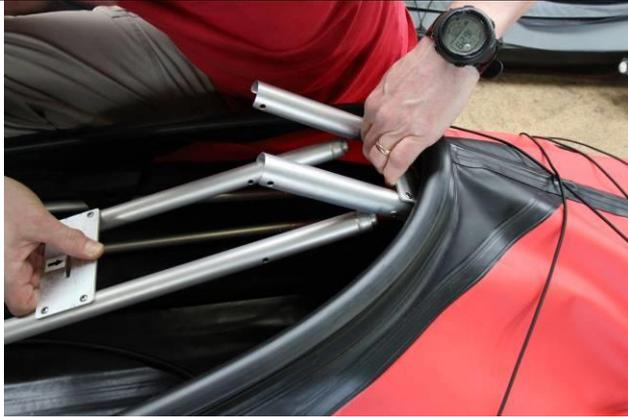
Wenn Sie das geschafft haben, können Sie beides langsam nach unten durchdrücken. Dadurch wird das Gestänge vollends in die Haut gepresst und die erste Spannung entsteht. Achten Sie bitte darauf, dass Sie beim Verspannen nicht Ihre Hände unter den Halbrohren oder dem Kiel haben!
