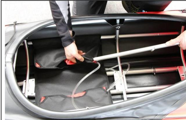
Sie benötigen dann pro Schenkelstütze eine der kurzen Schrauben (in aller Regel finden Sie diese am Spant) und eine lange Schraube, die am hinteren Ende der Schenkelstütze eingedreht ist. Nehmen Sie diese jeweils heraus.
