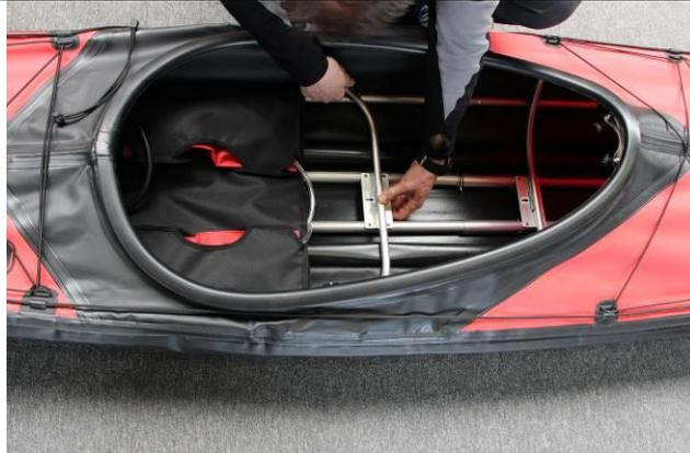
Setzen Sie dann den Halbspant ein. Dieser Spant hat keine Markierung und ist etwas breiter als der vordere Halbspant, welcher ein eingeschlagenes „H“ am oberen Ende aufweist.
