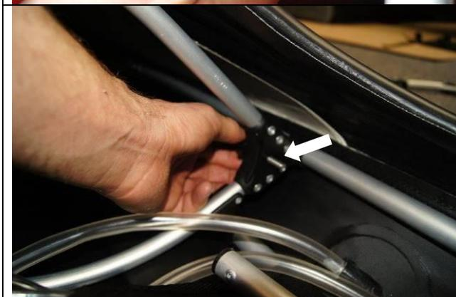
Stecken Sie dann bitte eine der längeren Arretierungsschrauben von hinten durch den hinteren Spant im Cockpit
