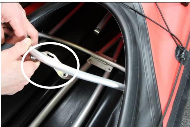
Setzen Sie zunächst den Spant #2 ein (gehört an den Anfang des vorderen Cockpits).
