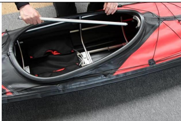
Installieren Sie den Firststab, indem Sie ihn vom hinteren Cockpit aus hineinschieben und vorne am Spant #3 in den Aufnehmer setzen:
