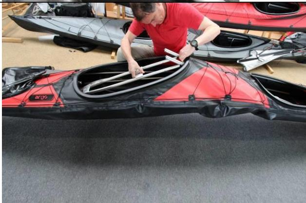
Entfernen Sie nun zuerst die beiden Splinte, welche jeweils in den Halbrohren stecken.
