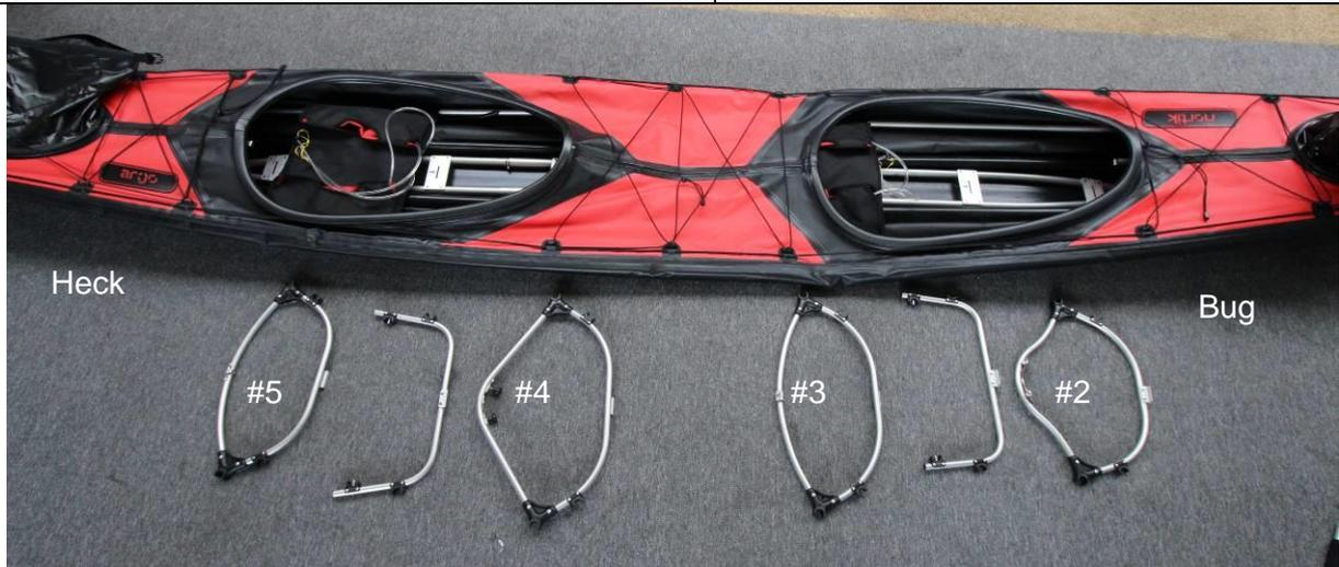
Es werden nun die übrigen Spanten eingesetzt. Oben sehen Sie die grundsätzliche Position. Spant #2 und Spant #4 verfügen über Halterungen für die Schenkelstützen, wobei Spant #4 der deutlich breitere ist. Spant #3 hat als einziger Spant den Beschlag für den mittleren, noch übrigen Firststab mit dem kugelförmigen Ende. Ferner ist Spant #3 breiter als Spant #5. Bezüglich der beiden Halbspanten beachten Sie bitte folgendes:
