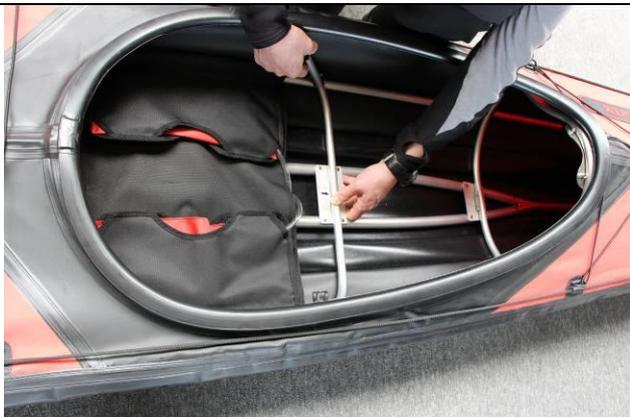
Nehmen Sie den Halbspant, welcher zum Bug gehört zur Hand (Unterscheidung der beiden Halbspanten siehe oben!!).
