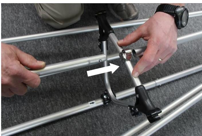
Nehmen Sie dann den längsten der drei Friststäbe zur Hand. Dieser wird nun durch die Halterung auf dem Spant #1 gesteckt und gleichzeitig in den Firststab geschoben, welcher fest am Bugsteven installiert ist.
