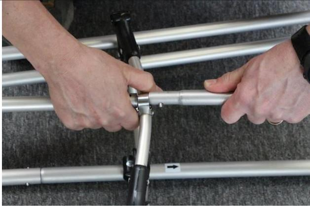
Analog zum Bug wird auch hier der Firststab durch die Halterung am Spant gesteckt und gleichzeitig in den Firststab geschoben, welcher fest am Bugsteven installiert ist.
