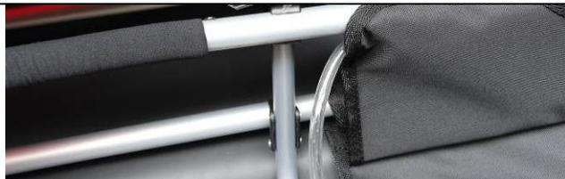
Clipsen Sie die Schenkelstützen jeweils in die Halterungen des Halbspants.
