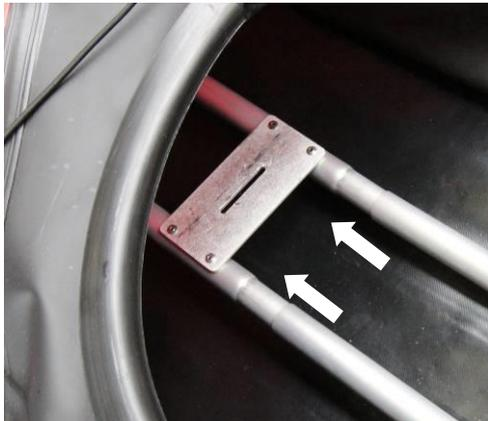
Nehmen Sie nun die Kielleiter zur Hand. Stecken Sie diese auf die offenen Enden der Kielgabel des Bugteils, welches Sie eben ins Boot geschoben haben.
