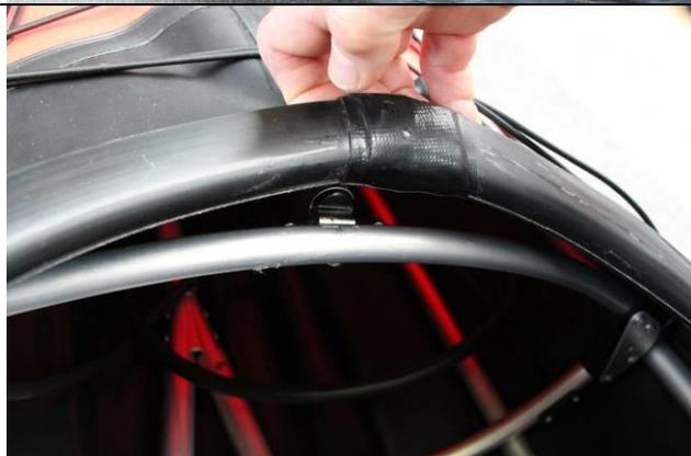
Analog dem Bugbereich muss hier der Firststab beim Aufrichten des Spants gleichzeitig nach oben gedrückt werden, damit er im nächsten Schritt in die Aufnahme am Spant greifen kann.
