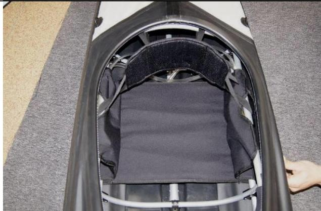
Die beiden mittleren Gurte befestigen Sie am hinteren Cockpit-Spant.
