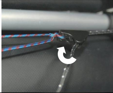
Setzen Sie dann das Pedal auf der gewünschten Position auf der Steuerschiene ein und spannen Sie das Seil in der Seilklemme. Spannen Sie es aber nur so stark, dass die Pedale noch genügend Spiel haben, um auch einen Steuerausschlag auszulösen. Führen Sie dann das Seil zur Sicherheit nochmals durch die Klemme.
