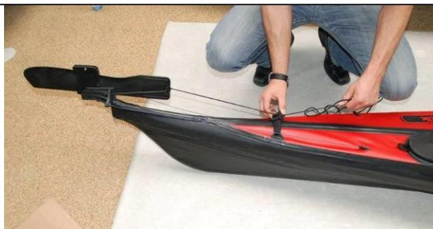
Führen Sie dann die Aufholleine, welche am Ruder befestigt ist, durch den hintersten D-Ring. Führen Sie die Leine weiter an der Ladeluke vorbei, durch die drei D-Ringe.
