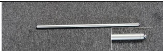
Nehmen Sie nun den noch verbleibenden mittleren Firststab zur Hand. Dieser hat auf der in Richtung Bug zeigenden Seite eine „Nase“, welche in den Spant #3 eingehängt wird. Die andere Seite hat den bereits bekannten Einhängebeschlag.
