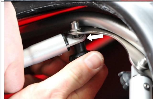
Setzen Sie dann zunächst vorne die Schenkelstütze an und befestigen Sie diese am Spant mit der kurzen Schraube.
