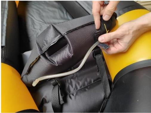
Der Befüllschlauch der Rückenlehne lässt sich mittels Klett an der Rückseite befestigen.
