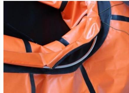
Das Cockpit wird dann um den Alusüllrand gelegt. Das fällt beim ersten Mal etwas schwerer und wird mit etwas Übung schnell leichter.
