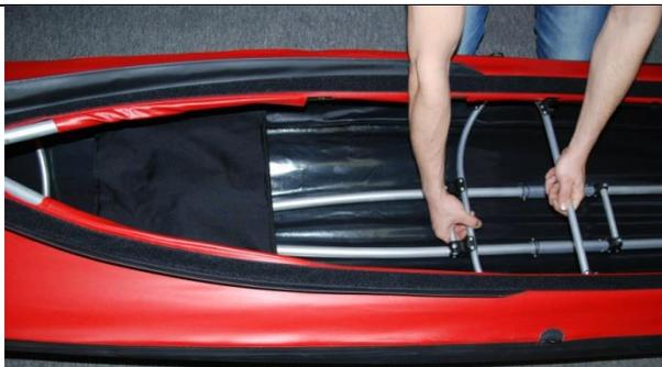
Schieben Sie den Vordersitz ganz nach vorne in den Bugbereich. Nehmen Sie dann den Spant #3 zur Hand und setzen diesen wie gewohnt schräg an.
