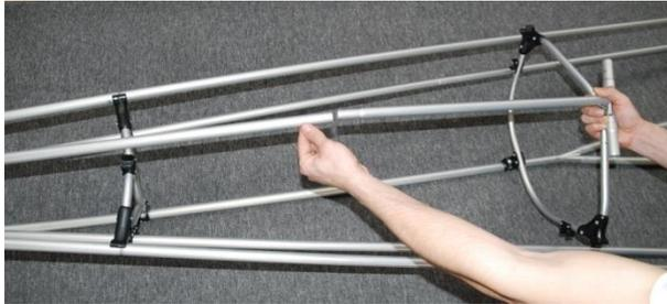
Das Einsetzen des Spants #2 und das Einführen des Firststabs in die Verlängerungssente muss gleichzeitig erfolgen.
