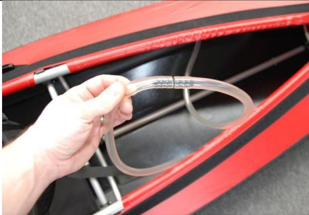
Blasen Sie nun bitte die seitlichen Luftschläuche auf. Diese werden danach mit Hilfe des Verbindungsrohres miteinander verbunden. So findet ein Druckausgleich statt, welcher ein stets symmetrisches Unterwasserschiff garantiert.
