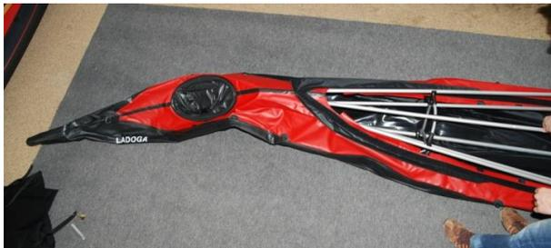
Breiten Sie die Bootshaut aus. Öffnen Sie die Ladeluke am Bug und öffnen Sie den Wickelverschluss. Führen Sie dann das Bugelement in die Bootshaut ein. Achten Sie darauf, dass Sie das Gestänge mittig einsetzen.
