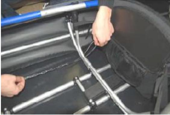
Führen dann die Schlaufe nach demselben Prinzip („durchschieben und durchfädeln“) um den Spant 2
