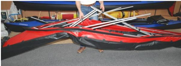
Nun wird Bug und Heck miteinander verspannt. Entfernen Sie dazu bitte erst die beiden Splinte der Kielleiter. Und gehen Sie dann bitte genau so vor wie beschrieben **und lesen Sie den Abschnitt bitte zunächst einmal durch** bevor Sie ans Werk gehen:
