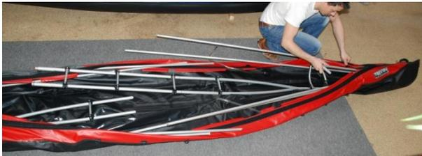
Verfahren Sie identisch mit dem Heck. Führen Sie auch hier das Gestänge **flach** und soweit wie möglich ein. Achten Sie darauf, dass Sie die Befüllschläuche für die seitlichen Luftschläuche zwischen die Senten nehmen.
