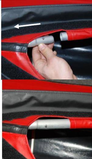
Verbinden Sie dann das Süllrandrohr mit dem Aufnehmer im Bug, indem Sie es darauf schieben. Hier können Sie den beweglichen Aufnehmer etwas zu sich her ziehen, so dass auch hier eine Art Gerade entsteht und so das Auffädeln des Süllrandrohres leichter ist.
