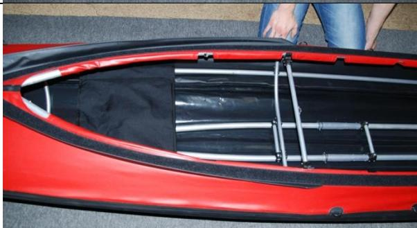
Richten Sie den Spant langsam auf. Achten Sie bitte darauf, dass Sie beim Aufrichten mit dem Spant nicht am Süllrandkanal hängen bleiben.
