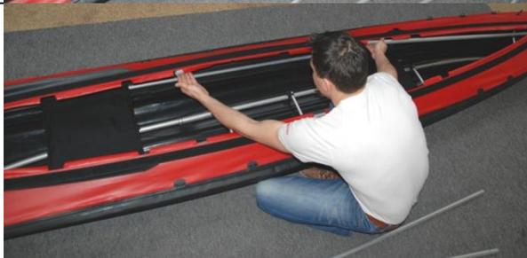
Schieben Sie dann die erste Hälfte des Süllrands durch den Kanal bis nach vorne durch. Gerade beim Erstaufbau muss man darauf achten, dass das Rohr im Kanal läuft.
