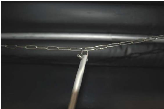
Platzieren Sie dann den Steuerbalken an der gewünschten Stelle, indem Sie die Scheffel durch das gewünschte Kettenelement führen und den Stift durch das Loch am Steuerbalken.
