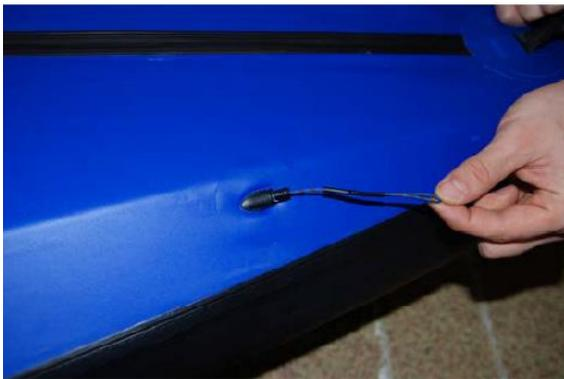
Dann führen Sie die Steuerleinen jeweils über die Spanten hinten vorsichtig durch die Steuerleinendurchführungen (Auslassschläuche).
