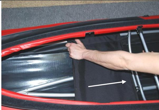
Ziehen Sie den Vordersitz nun etwas nach hinten in Richtung des Spant #3 (lassen Sie ca. 8 cm Platz – die letztlich ideale Position werden Sie selbst für dich herausfinden müssen).
