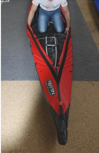
Orientieren Sie sich am Firststab und dem Decksverstärkungsstreifen, um das Gestänge gerade und mittig einzuführen. Auch ein Blick durch die Ladeluke kann helfen.
